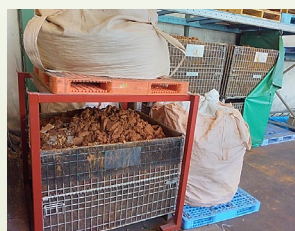
スラッジの乾燥放置処理
